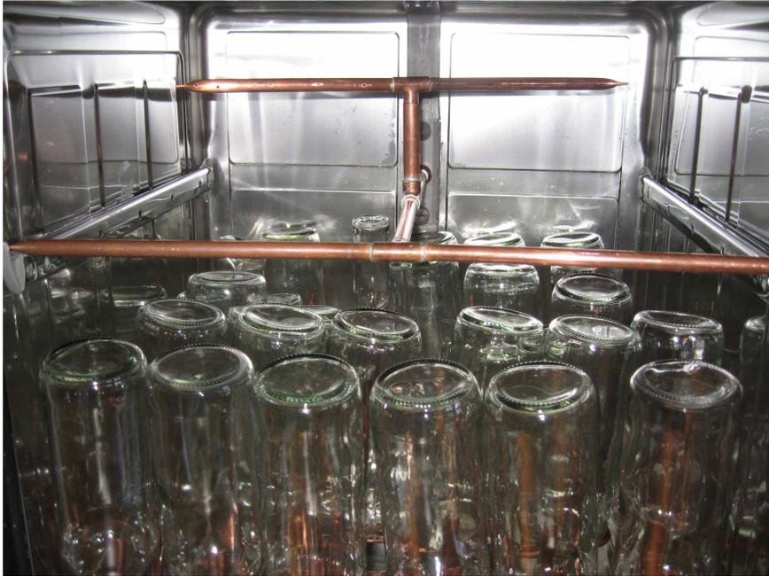
Der Spritzrotor mit dem T-Stück wird in den Wasserzufuhrstutzen an der Rückwand eingesteckt. Je nachdem, eines der beiliegenden Kupferrohr-Reduzierstücke (siehe Bild unten) verwenden oder rausziehen.
