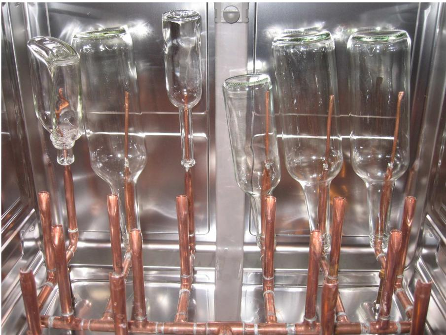
Mit dem Flaschenspüler werden auf einmal 32 Flaschen ab 17 mm Öffnung, (**optional auch 4mm Aufsatzröhrchen für die 0,1l Opera**, siehe Bild im hinteren Bereich) Spezial-Flaschen wie Opera, besonders die Likörflaschen blitzblank (sauberer als von der Fabrik).
