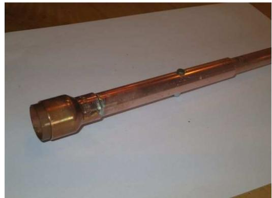
Das T-Stück muß mit der Schraube in der Länge so eingestellt werden, dass es ohne größeres Spiel im Wasserzufuhrstutzen steckt, wenn die Tür geschlossen ist. Ansonsten kann es evtl. rausfallen. Ggfs. auch an den beiden oberen „T“-Balken biegen.
